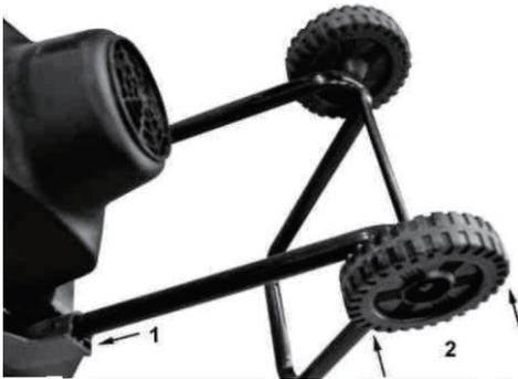
1. Присоедините основание к нижней части корпуса измельчителя (рис. 3(1)).
